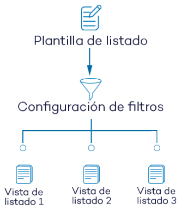
Figura 3.10: Generación de tres listados a partir de una misma plantilla / fuente de datos
